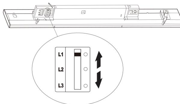
Les drivers sont mobiles afin de faciliter l'implantation des luminaires pour éviter les accessoires de jonctions sur les rails, cela permet de répartir les luminaires sans contrainte sur la ligne .
